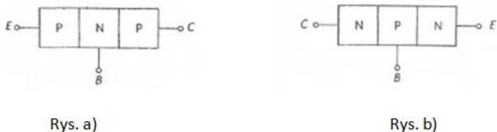
Rys. 1.7. Modele tranzystorów [2]: a) typu P-N-P , b) typu N-P-N .
