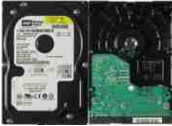
Dysk twardy 3,5" widziany z góry (po lewej) i od dołu (po prawej)
