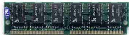
Pamięć typu SIMM 72 pin - stosowana w komputerach PC AT-486 i Pentium 60-233MHz
