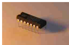
Pamięć typu DIP - stosowana w komputerach PC XT, AT -286
