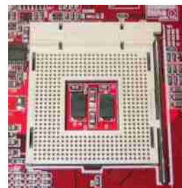
Socket 478 ; typ ZIF rzędy pinów 26*26 FSB 400, 533, 800 MHz procesory- Pentium 4, Celeron, Celeron D, Pentium 4 Extreme Edition
